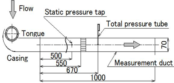
**Fig. 1 Experimental apparatus**
